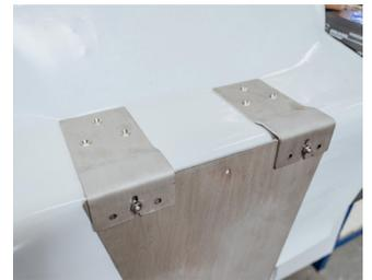
► Plaquer les deux platines contre les parois et bloquer la bague inox contre l'axe.
