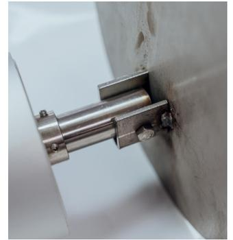
► Bloquez l'axe à l'aide de la vis et passez le câble moteur dans la nervure de la platine.
