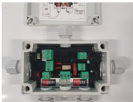
Un régulateur assure la gestion de la charge et de la décharge pour éviter un vieillissement prématuré de la batterie.
